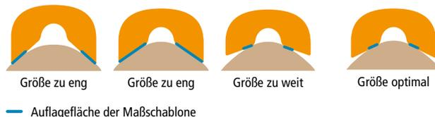
Die Höhe der Schablonen entspricht **NICHT** den Wechselzwiesel, die Wechselzwiesel lassen später ausreichend Platz für den Widerrist.
